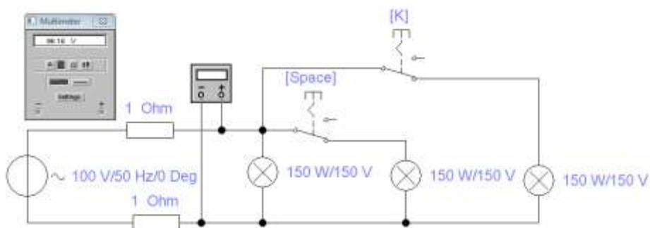
По мере увеличения количества подключаемых лампочек напряжение на них уменьшается. Потери напряжения в линии возрастают с 1,3 % до 3,9 %.
