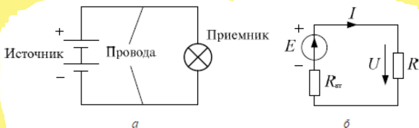
Рис. 3.1. Простейшая электрическая цепь: а – принципиальная схема; б – расчетная схема замещения
