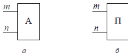
Рис. 3.10. Условное обозначение двухполюсников: а – активного; б – пассивного
