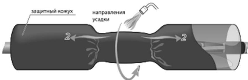
**8.1** Надвинуть на муфту защитный кожух. Расположить его симметрично относительно центра муфты.
