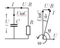
совпадает с напряжением). Сумма I токов поляризации и потерь опережает по фазе напряжение U на угол  $\phi$  близкий к 90°. Угол  $\delta$ , дополняющий угол  $\phi$  до 90°, называется *углом потерь*. Тангенс угла
