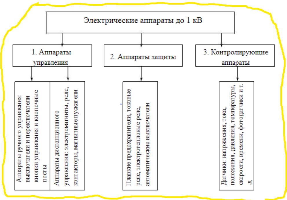
Рис. 1.1. Классификация электрических аппаратов
