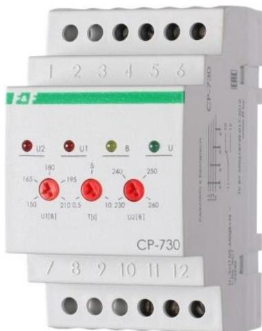
Реле контроля напряжения CP-730 предназначено для непрерывного контроля величины напряжения в сети переменного тока в трёхфазной сети и защиты электроустановок, электроприборов и т.п. путём отключения напряжения питания при выходе его за установленные пределы. CP-730 защищает также электроустановки при обрыве нулевого провода. Реле включено, если контролируемое напряжение находится в требуемом диапазоне. Диапазон (верхнее и нижнее значение)
