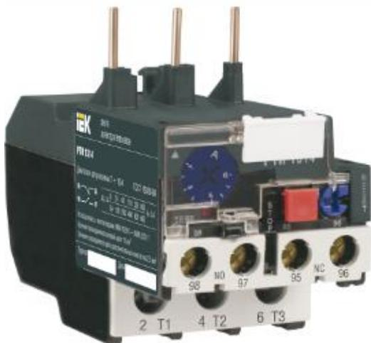
Реле электротепловое серии РТИ является электрическим коммутационным устройством, имеющим собственное потребление энергии. Электротепловое реле серии РТИ предназначено для защиты электродвигателей от перегрузки, асимметрии фаз, затынутого пуска и заклинивания ротора. Устанавливается непосредственно на контакторах серии КТИ и КМИ.
