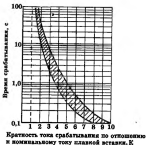
Рис. 4.1. Защитная характеристика предохранителей
