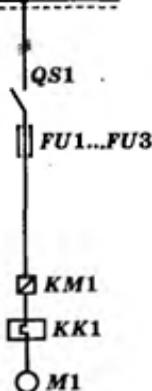
Рис. 4.18. Схема защиты электрической сети отключения к электродвигателю
