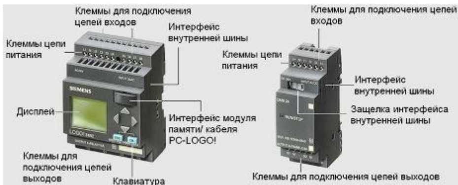
Рисунок 1 – Конструкция контроллера LOGO! Basic и модуля расширения
