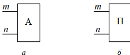
Рис. 3.10. Условное обозначение двухполюсников: а – активного; б – пассивного
