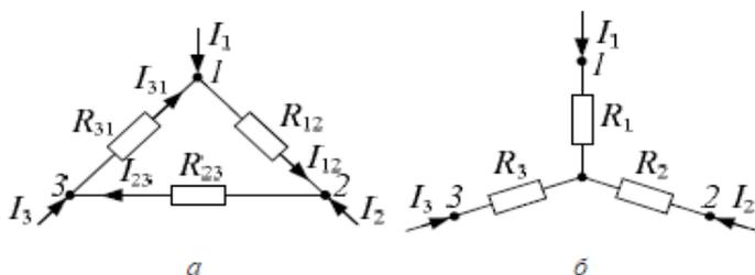
Рис. 4.9. Схемы соединения приемников: *a* – треугольником; *б* – звездой
