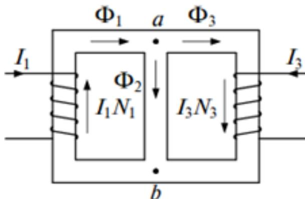
**Решение.** Укажем направления МДС  $I_1N_1$  и  $I_3N_3$ , используя правило правоходового винта. Произвольно выберем и укажем на схеме положительные направления магнитных потоков. Обход по контурам – по часовой стрелке.
