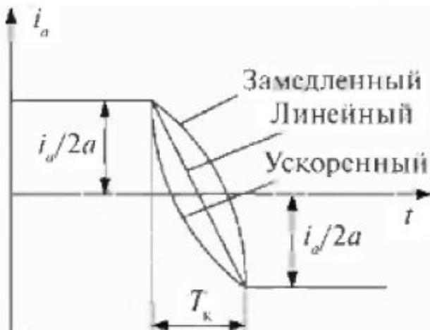
Рис. 1.25. Характер изменения тока в коммутируемой секции
