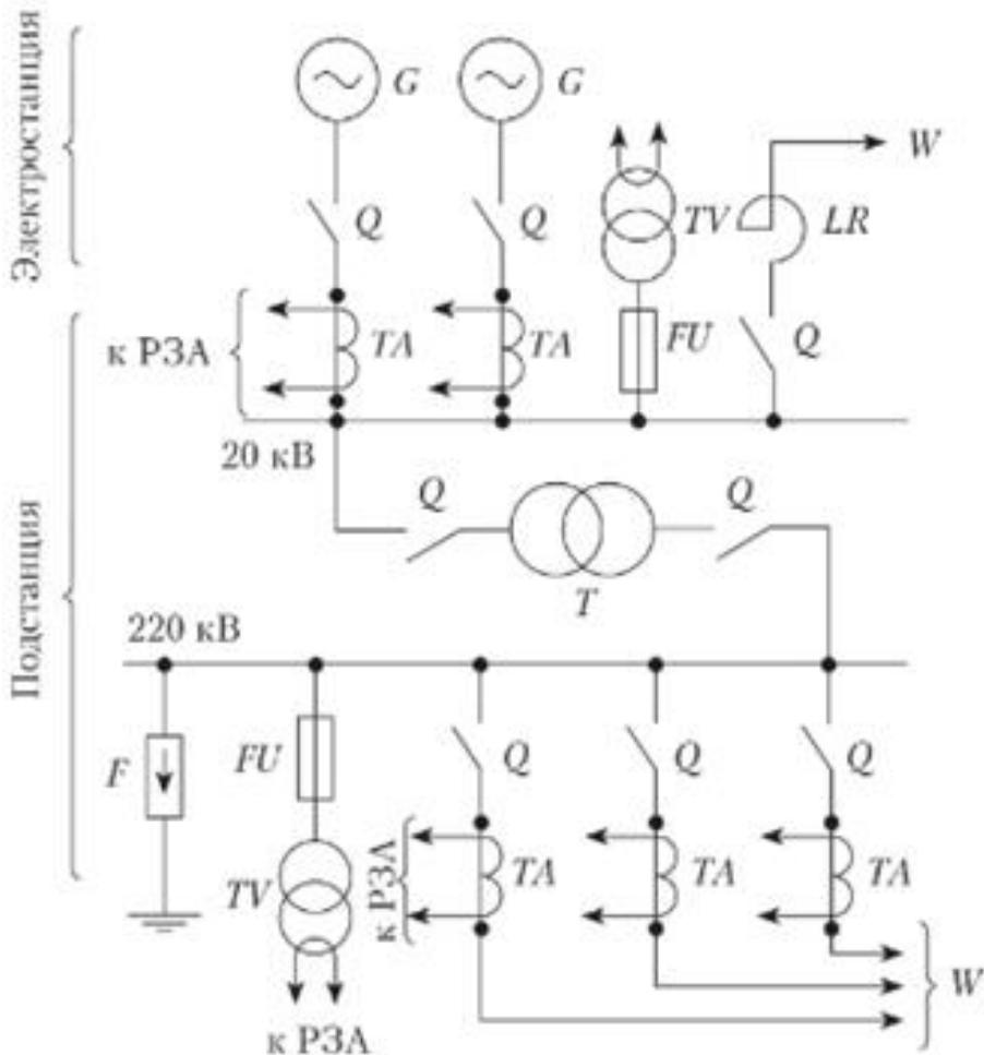
От генераторов  $G$  через выключатели  $Q$  напряжение подается на сборные шины. Силовой трансформатор  $T$  преобразует генераторное напряжение ( $20 <B$ ) в более высокое ( $220 \text{ кВ}$ ) для передачи его на дальние расстояния через линии электропередачи  $W$ , оперативные коммутации которых осуществляются выключателями.
