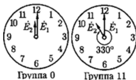
Рис. 1. Сравнение положения стрелок часов с обозначением групп соединения
