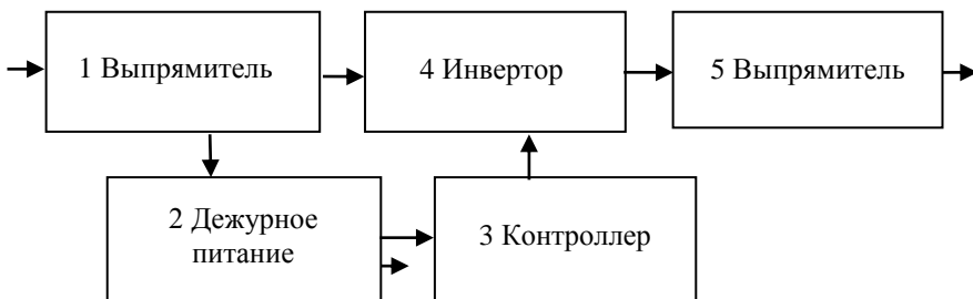
Рисунок 8 – Блок-схема импульсного блока питания компьютера
