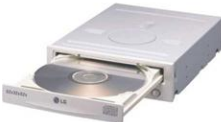
Рисунок 16 – Оптический привод для CD/DVD
