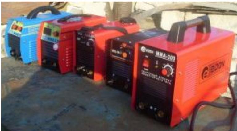
Рисунок 108 – Инверторные источники сварочного тока
