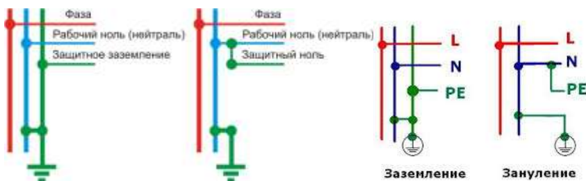
Рисунок 70 – Отличие защитного заземления и защитного "нуля"
