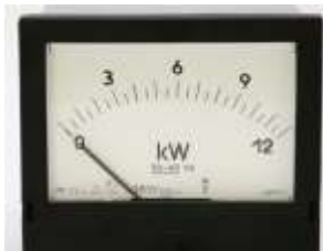
Рисунок 23 – Электродинамический ваттметр (а) и цифровой измерительный прибор для измерения электрических величин (б)
