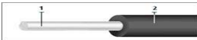
Рисунок 64 – Провод ПНСВ (ТУ 16.К71-013-88)
