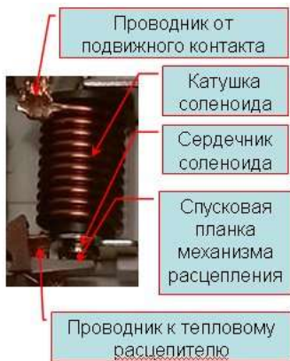
Рисунок 60 – Электромагнитный расцепитель
