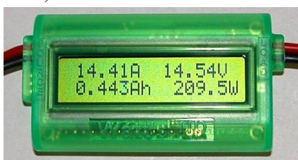
Рисунок 23 – Электродинамический ваттметр (а) и цифровой измерительный прибор для измерения электрических величин (б)
