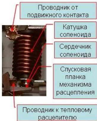
После подачи напряжения на цепь управления независимого расцепителя его электромагнитный механизм воздействует на удерживающее приспособление автоматического выключателя, инициируя размыкание контактов его главной цепи. Управляющий сигнал для независимого расцепителя может быть
