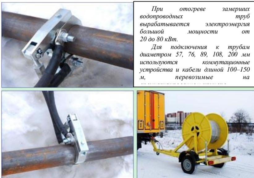
Рисунок 66 – Электрообогрев металлического трубопровода
