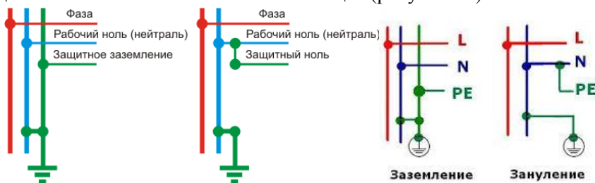
Рисунок 70 – Отличие защитного заземления и защитного "нуля"
