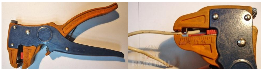
Рисунок 1 – Применение стрипперов для зачистки проводов ( https://rmnt.ru )
