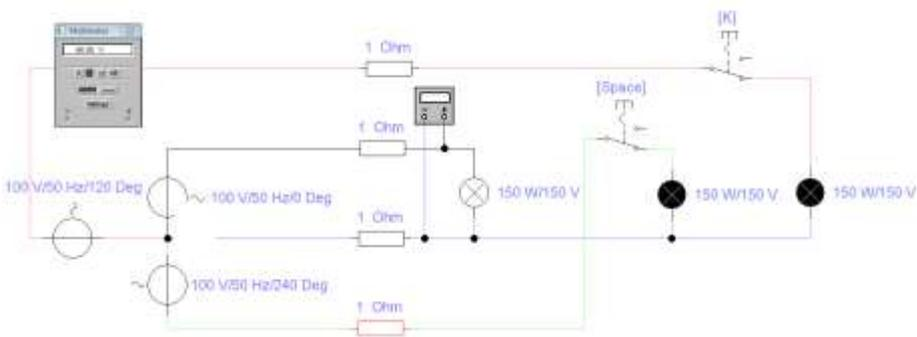
По мере увеличения количества подключаемых лампочек напряжение на них повышается. Потери напряжения в линии уменьшаются с 1,3% до 0,65%, то есть в два раза. По сравнению с однофазной линией с тремя лампочками в трёхфазной потери меньше в 6 раз.
