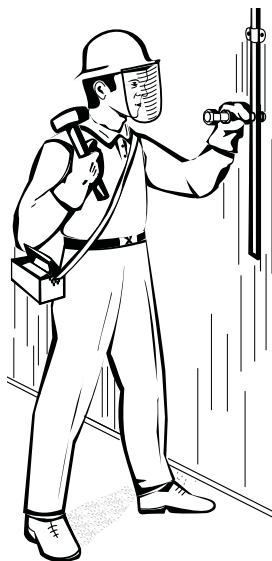
Рис. 3.12. Применение оправки ОДП
