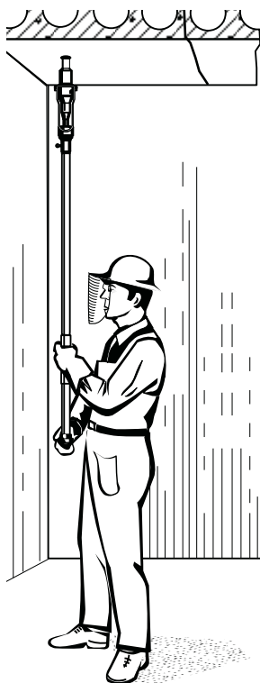
Рис. 3.14. Пробивка отверстия в плите перекрытия помещения при помощи колонки УК-2М
