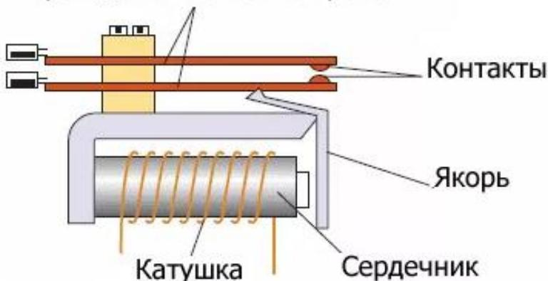
Реле до сих пор очень широко применяются в бытовой электротехнике, в особенности для автоматического включения и выключения электродвигателей (пускозащитные реле), а также в электрических схемах автомобилей. Например, пускозащитное реле обязательно имеется в бытовом холодильнике, а также в стиральных машинах. В этих устройствах реле намного надёжнее электроники, так как оно устойчиво к броску тока при запуске [электродвигателя](#) и, особенно, к сильному броску напряжения при его отключении.
