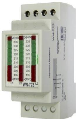
Указатель напряжения предназначен для отображения на светодиодной шкале величины напряжения в отдельных фазах трёхфазной сети. Диапазон измеряемых напряжений - от 190 до 240В с дискретностью 5В, трёхфазный, светодиодная шкала, 2 модуля, монтаж на DIN-рейке.
