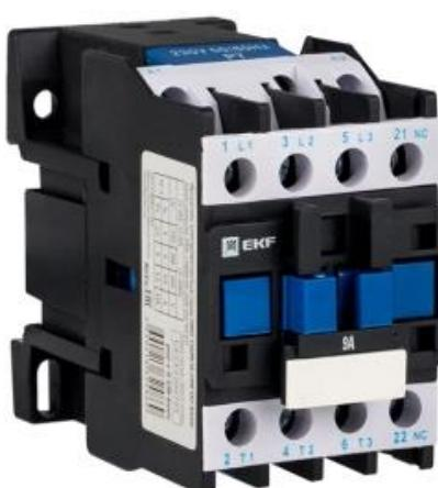
Пускатели ПМЛ EKF Basic состоят из корпуса, закрепленных в нём неподвижных контактов, подвижных контактов, которые закреплены в подвижной части магнитной системы. Неподвижная часть магнитной системы закреплена жёстко в корпусе ПМЛ. Пружина препятствует смыканию контактов.
