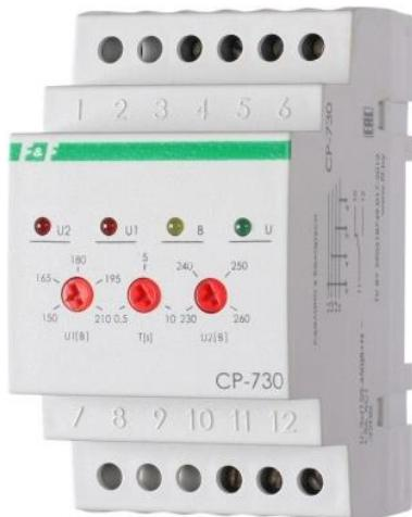
Реле контроля напряжения СР-730 предназначено для непрерывного контроля величины напряжения в сети переменного тока в трёхфазной сети и защиты электроустановок, электроприборов и т.п. путём отключения напряжения питания при выходе его за установленные пределы. СР-730 защищает также электроустановки при обрыве нулевого провода. Реле включено, если контролируемое напряжение находится в требуемом диапазоне. Диапазон (верхнее и нижнее значение) устанавливается с помощью
