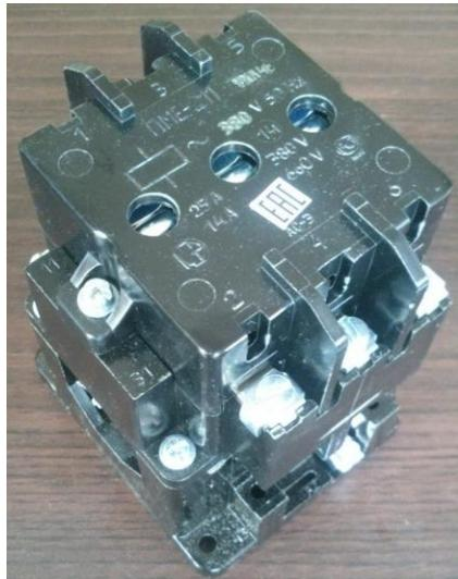
Пускатели электромагнитные предназначены для применения в стационарных установках для дистанционного пуска непосредственным подключением к сети, остановки и реверсирования трехфазных асинхронных электродвигателей с короткозамкнутым ротором переменного напряжения 660 В частоты 50 и 60 Гц. При наличии трехполюсных тепловых реле серий РТТ и РТЛ пускатели осуществляют защиту управляемых электродвигателей от перегрузок недопустимой продолжительности и от токов, возникающих при обрыве одной из фаз
