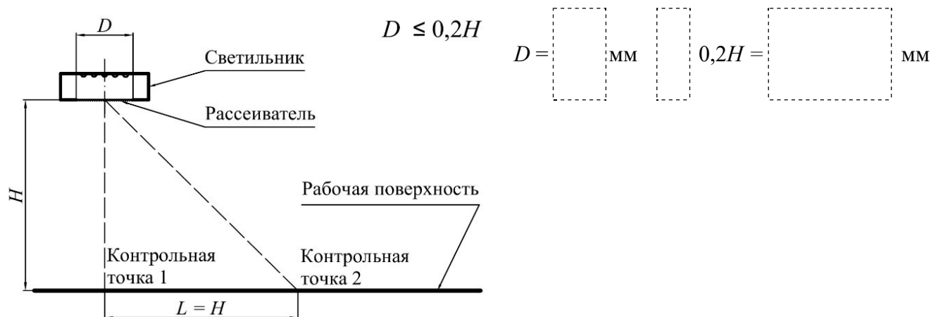
Рисунок 5.2 – Геометрическая модель осветительной установки
